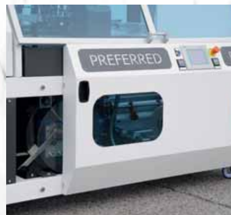
Unità svolgibobina e raccoglifrigo entrambi posti frontalmente con porta scorrevole, facili da raggiungere. Svolgibobina estraibile.
