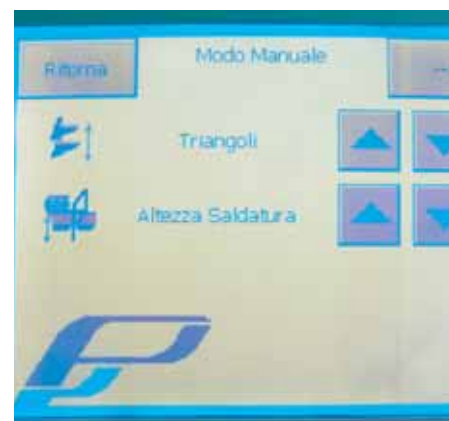
Facili cambi formato: centro di saldatura e triangolo motorizzati. Altezza fino a 400 mm.
