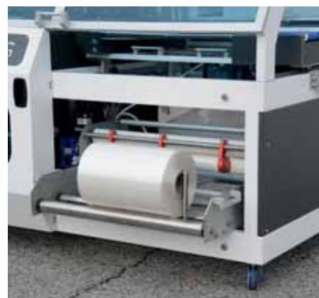
Unità svolgibobina e raccoglifrigo entrambi posti frontalmente con porta scorrevole, facili da raggiungere. Svolgibobina estraibile.
