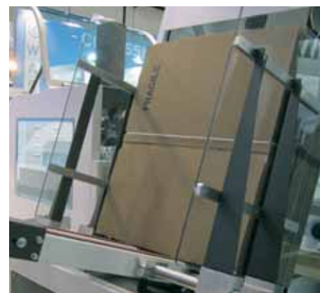
Gruppo di formatura cartone con magazzino cartoni
