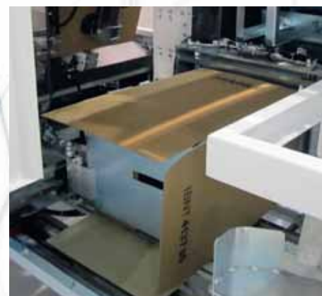
Srombatura cartone in automatico ed inserimento del gruppo di prodotti nello stesso
