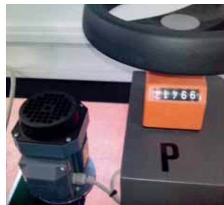
Regolazioni motorizzate per cambi formato veloci e precisi.
