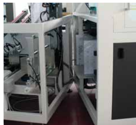
Sistema di carico separabile per maggiore accessibilità dell'operatore.
