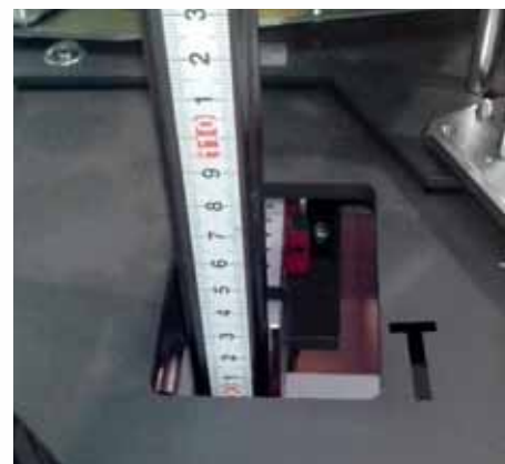
Regolazioni e movimenti su guide lineari a coda di rondine con righe metriche.
