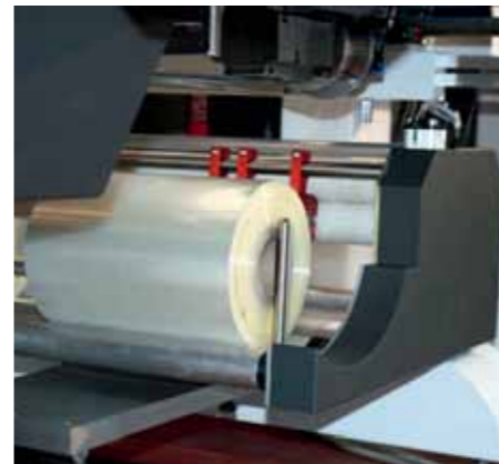
Folienlagereinheit kann mit Halbschlauchfolie oder mit Flachfolie arbeiten, patentiertes System.
