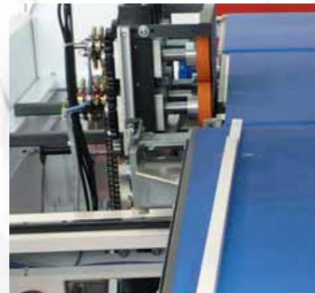
Reduzierter Abstand zwischen Seitenschweißung und Produkt - 10 cm Foliensparnis pro Verpackung.
