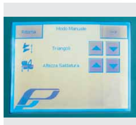
Cambio de formato sencillo: Altura de soldadura y triángulo motorizado. Altura hasta 400 mm.
