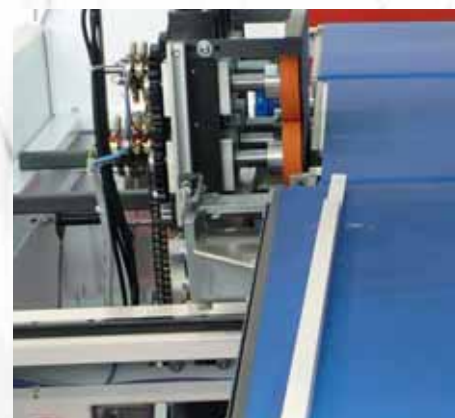
Distancia reducida entre rueda soldadura y film. Ahorro de 10 cm de film cada producto.
