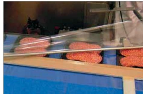
Può utilizzare Film neutri o stampati, Film monopiega o foglia piana (quali POLIOLEFINA, POLIPROPILENE, BOPP, PE e Film a Barriera). Anche per confezione in atmosfera modificata/sottovuoto con saldature ermetiche.
