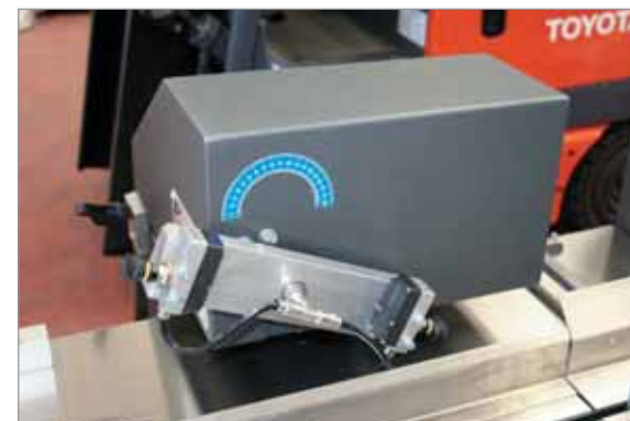
Apripagina: che consente di aprire la pagina per poi inserire inserti di vario genere. Page Opener: opens the first page to insert flyers or publicity.
