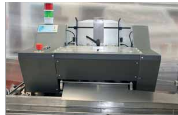
Caricatore Rotativo: pone all'interno del prodotto aperto un inserto. Rotary Feeder: puts inside the open product a supplement.
